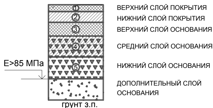
Рисунок 8.5 – Схема конструкции дорожной одежды
