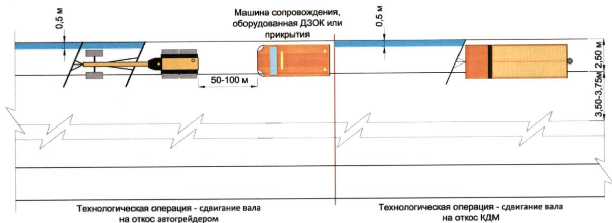
Рисунок 7.3.7- Сдвигание снежных валов за пределы бровки земляного полотна автомобильной дороги (скорость движения при уборке автогрейдером 20-30 км/ч, скорость движения при уборке КДМ с применением скоростного переднего отвала 50-90 км/ч).
